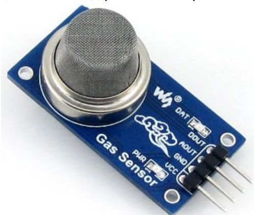
Рис. 5. Газовий датчик MQ-2
