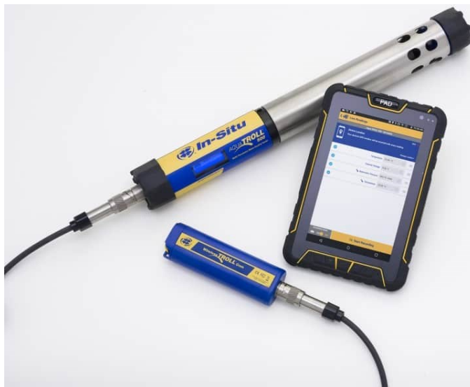
Рис. 5. Датчик Aqua TROLL 500 для визначення наявності домішок у воді
