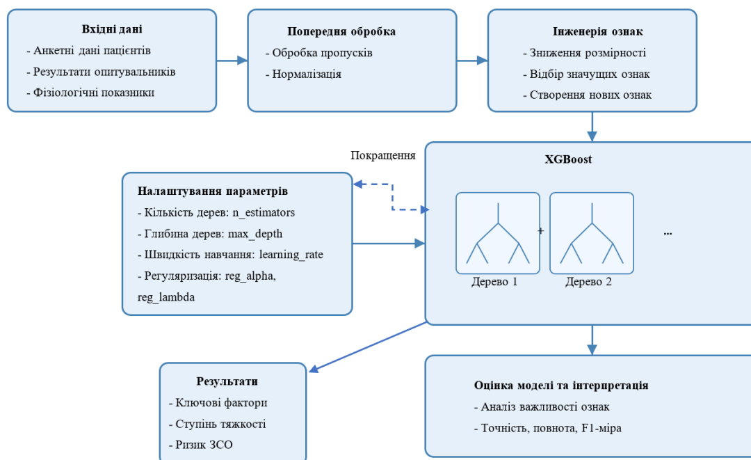
Рис.4. Схема застосування алгоритму XGBoost для прогнозування захворювання сухого ока
