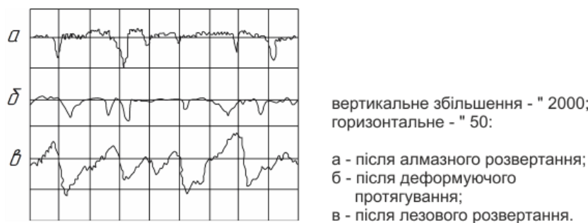
Рис. 7 Профілограми мікронерівностей отвору корпусу гідропідсилювача, отриманих різними способами обробки
