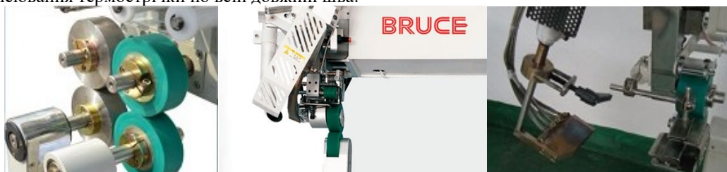
Рис. 7. Основні робочі органи обладнання, що застосовується для герметизації швів
