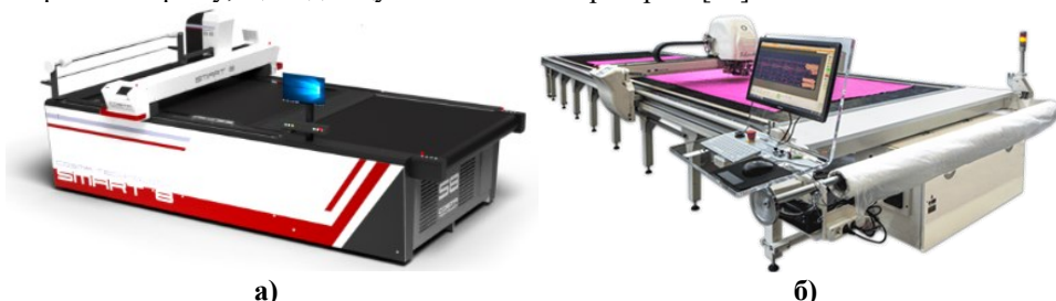
Рис. 1. Автоматизовані розкрійні комплекси: а) Smart 8; б) F.K. Group Biliardo 25-60-80
