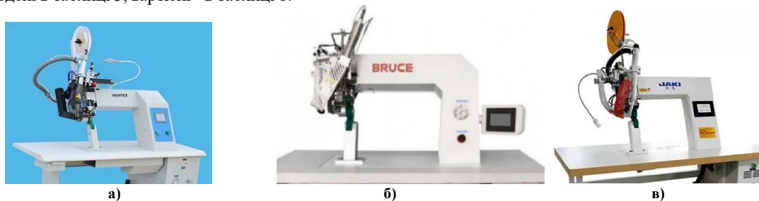
Рис. 8. Машини для герметизації швів: а) HIGHTEX S300; б) BRUCE BRC-6200; в) JAKI VP-10
