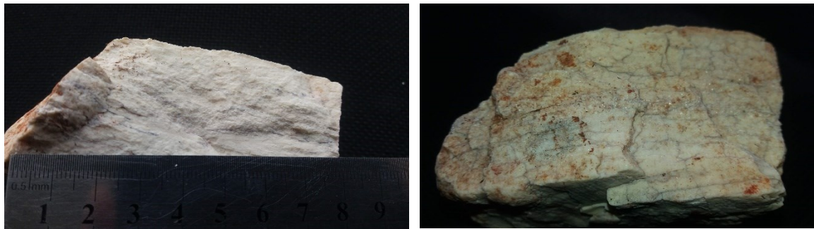
Рис. 4. Вигляд зразків з торців а) монолітний дрібнокристалічний б) дрібнотріщинуватий з включеннями мусковіту
