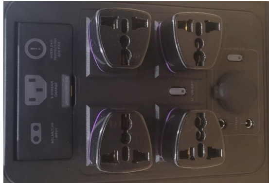
Рис.3. Підключення перехідника до китайської версії зарядної станції EcoFlow Delta.
