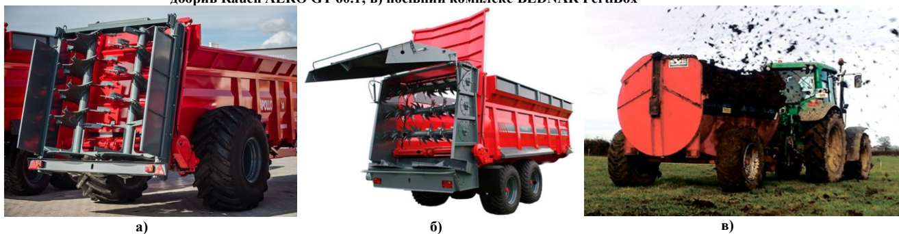
Рис. 2. Розкидачі органічних добрив: а) з вертикальними лопатевими валами; б) горизонтальними лопатевими валами; в) з ланцюгово-молотковим розкидним пристроєм
