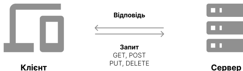
Рис. 1. Модель REST API застосування
