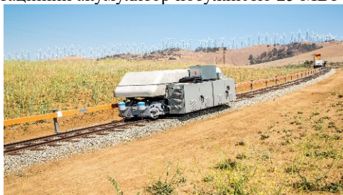
Рис. 3. Технологія ARES (залізничне накопичення енергії)
