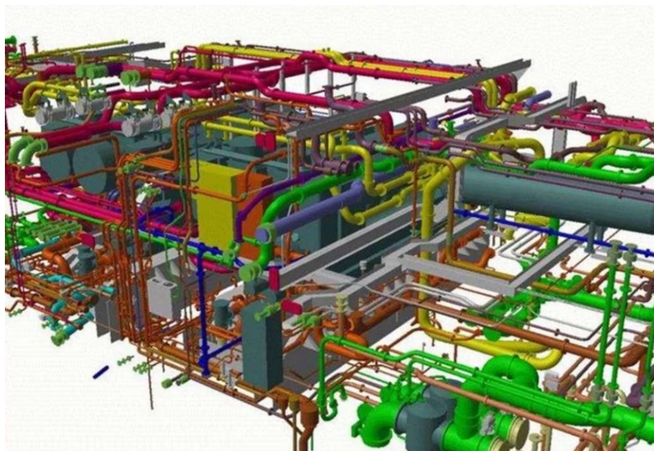
Рис. 10. Приклад систем суднових трубопроводів позначених різними кольорами
