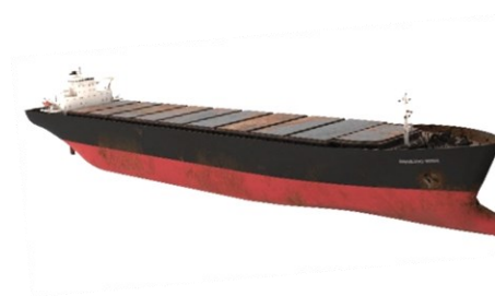
Рис. 4. Балкери без розвантажувального обладнання
