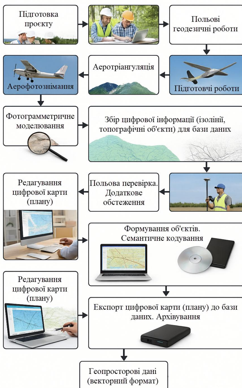
Рис. 1. Технологічна схема виробництва цифрових карт та планів
