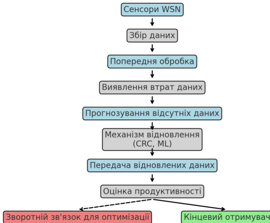
Рис.1 Структурна схема процесу відновлення втрачених даних у бездротовій сенсорній мережі
