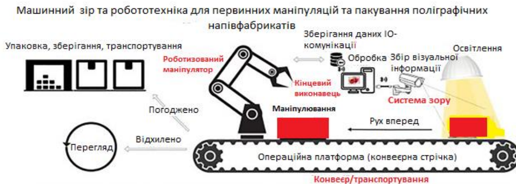
Рис. 1 Компоненти типової системи машинного зору у співпраці з роботизованою системою для затвердження якості поліграфічних напівфабрикатів
