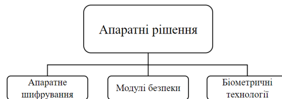
Рис.1. Основні види апаратних рішень захисту
