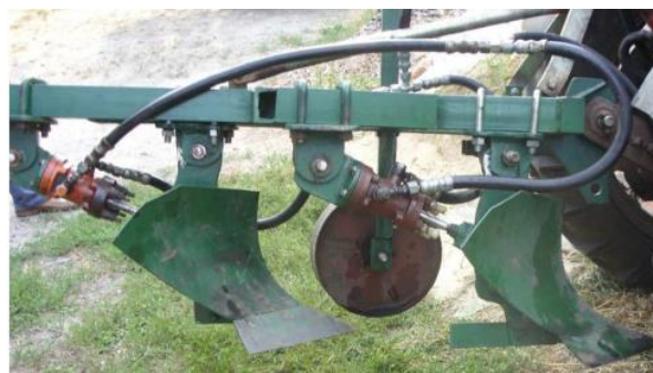
Рисунок 3. Вібраційний плуг з гідравлічними вібраторами: а) конструктивна схема; б) експериментальний зразок
