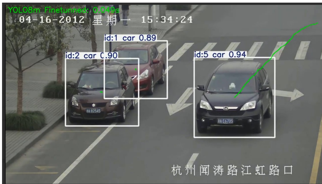
Рис. 3. Приклад кадру відео з детекцією та трекінгом автомобілів за допомогою дотренованої моделі YOLOv8m (Fine-tuned)
