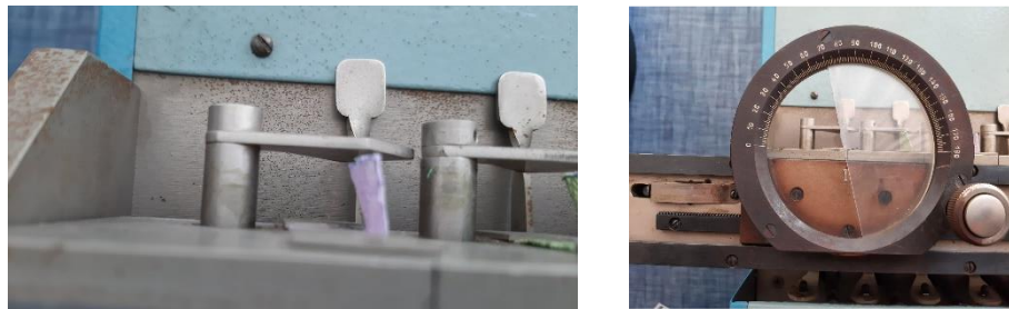
Рис. 3. Процес вимірювання незминальності зразків серветок напіввлляних українського виробництва на приладі CMT-M
