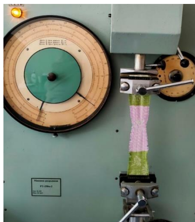
Рис. 2. Процес дослідження показників міцності зразків серветок напівлляних українського виробництва на розривній машині PT-250 м-2
