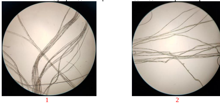
Рис. 1. Результати мікроскопічного дослідження зразків серветок українського виробництва: 1 – льняні волокна (по основі); 2 – бавовняні волокна (по утку)
