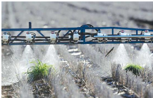
Рис. 5. Встановлені на штанзі сенсори WeedSeeker регулюють подачу робочого розчину на форсунки, під якими знаходиться бур'ян
