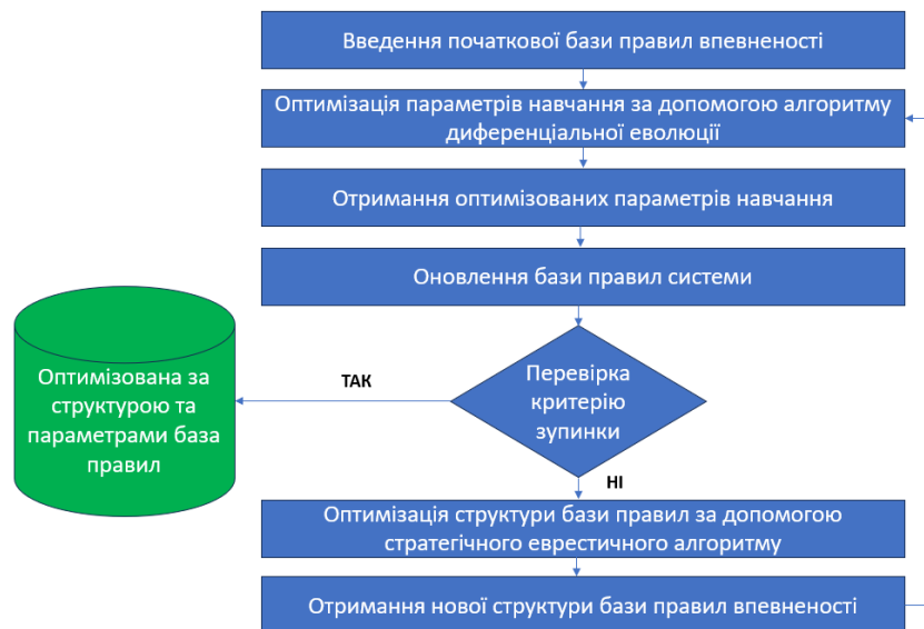
Рисунок 4 – Алгоритмічна схема механізму роботи ІСПВ з використанням підходу диференціальної еволюції
