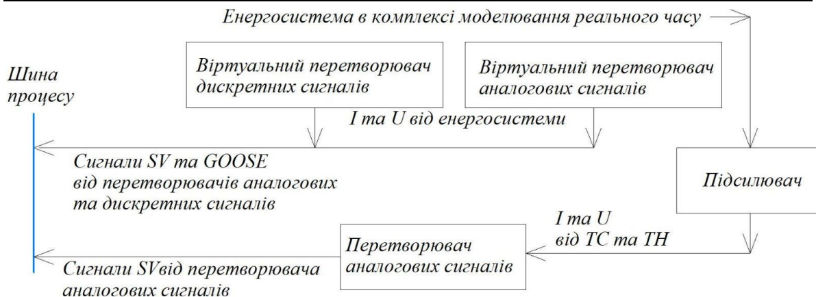
Рис.5. Застосування тренажерного комплексу реального часу для впровадження цифрових підстанцій
