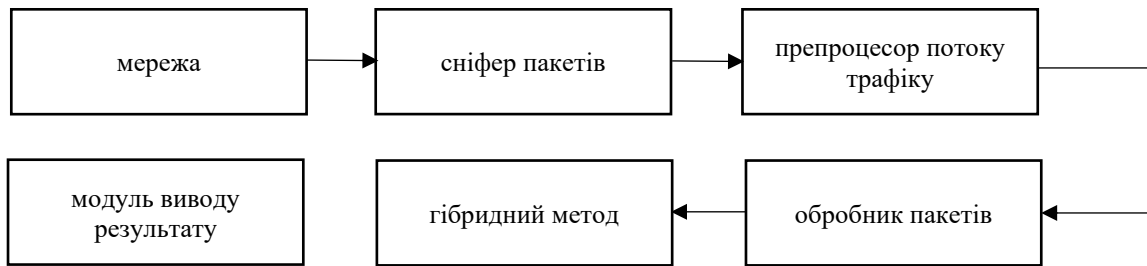
Рис. 1. Алгоритм роботи Snort із використанням гібридного методу виявлення аномального трафіку в ІКС
