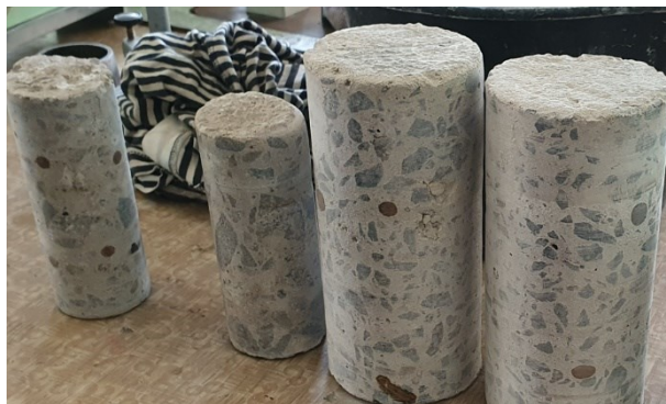
Рис. 1. Вигляд вихідних зразків циліндрів до обробки опорних поверхонь
