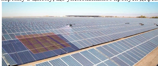
Рис. 5 Автоматизований візуальний або тепловізійний метод контролю
