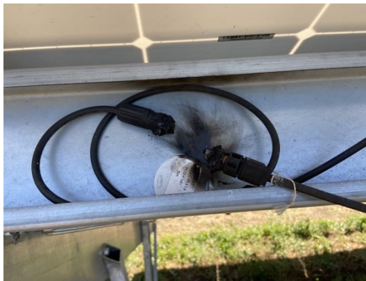
Рис. 14 Пошкодження конектора ФЕМ
