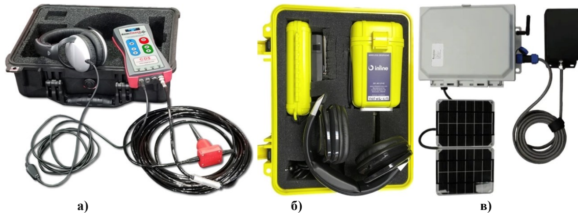
Рис 2. Реалізації засобів моніторингу на основі геофонів: а) SoniTrack Geophone, б) Wireless Geophone model VHFWG, в) SeniMax™ 3D Wireless
