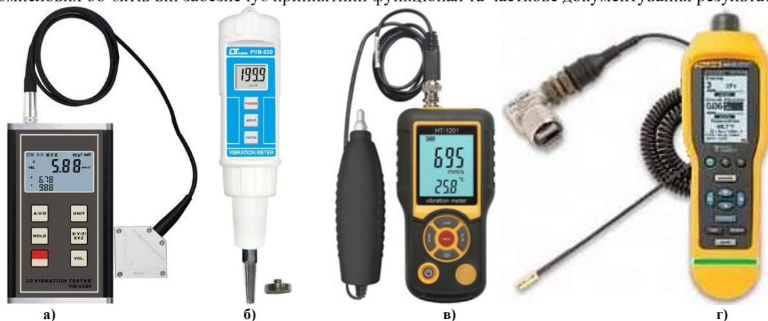
Рис 4. – Реалізації засобів моніторингу на основі п'єзоелектричних сенсорів а) Walcom VM-6380, б) Lutron PVB-820, в) Walcom HT-1201, г) Fluke 805 FC
