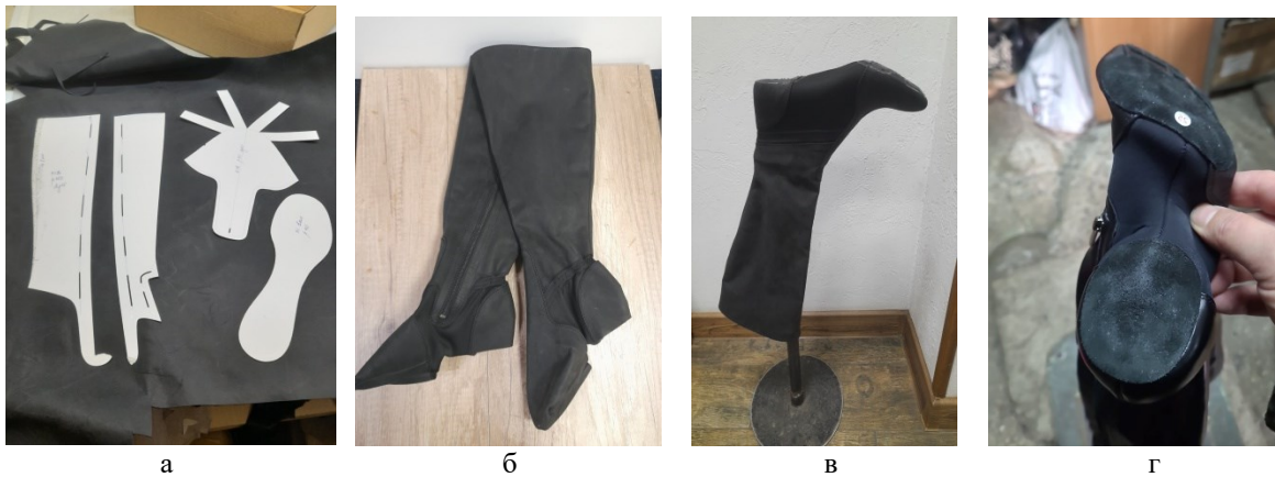
а – розкладка лекал на матеріалі, розкрій; б – виготовлення заготовки; в – формування взуття на колодці; г – фіксація елементів підощви на сліді взуття Рис.4. Візуалізація основних технологічних етапів виготовлення взуття «Ічиги»
