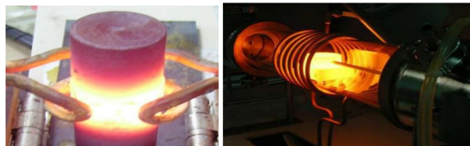
Рис. 7. Локальний та об'ємний індукційний нагрів заготовок
