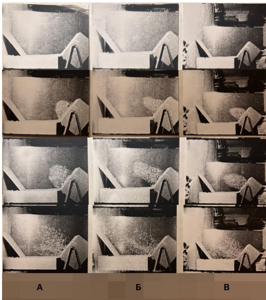
Рис. 2. Кадри швидкісної кінозйомки процесу вибуху (А – зосереджений заряд; Б – кільцевий заряд; В – заряд 2/3 кола; час між кадрами – 0,06 с)
