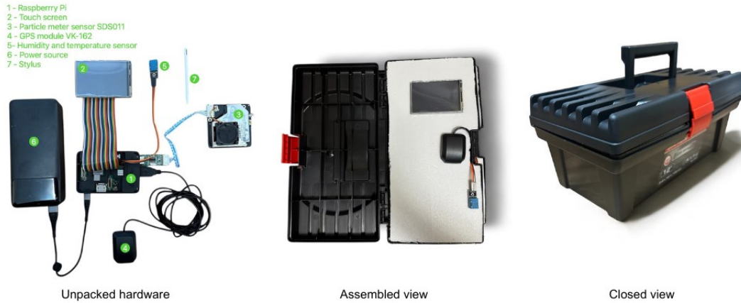
Рис. 5. Інтеграція елементів станції з Raspberry Pi
