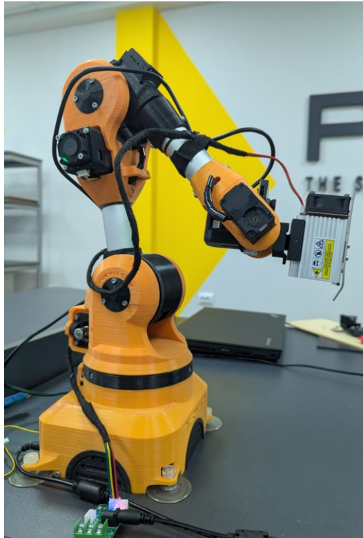
Рис.4. Роботизована рука з лазерною головкою
