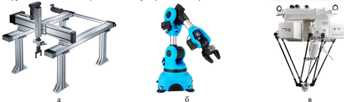
Рис.1. Роботизовані системи: а – картезіанська; б - шарнірно-зчленований маніпулятор; в - дельта-робот
