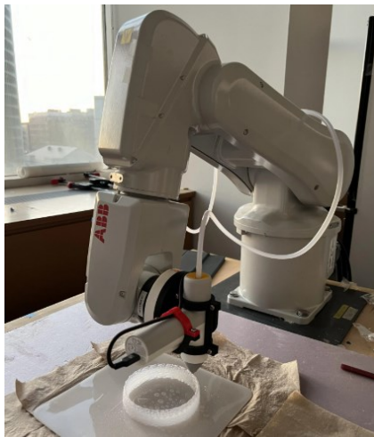
Рис.5. Робот-маніпулятор ABB, оснащений системою для 3D-друку: а – модель IRB 1200; б – модель CRB 15000
