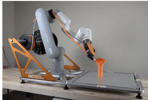
Рис.5. Робот-маніпулятор ABB, оснащений системою для 3D-друку: а – модель IRB 1200; б – модель CRB 15000
