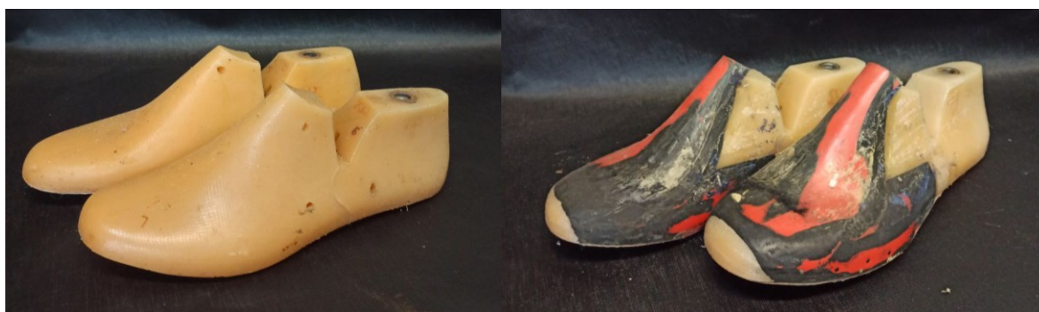
а – стандартна зчленована колодка(початковий етап); б – стандартна зчленована колодка(кінцевий етап) Рис. 3. Візуалізація етапів підготовки (нарощування) стандартної колодки для виготовлення взуття для проблемних діабетичних стоп
