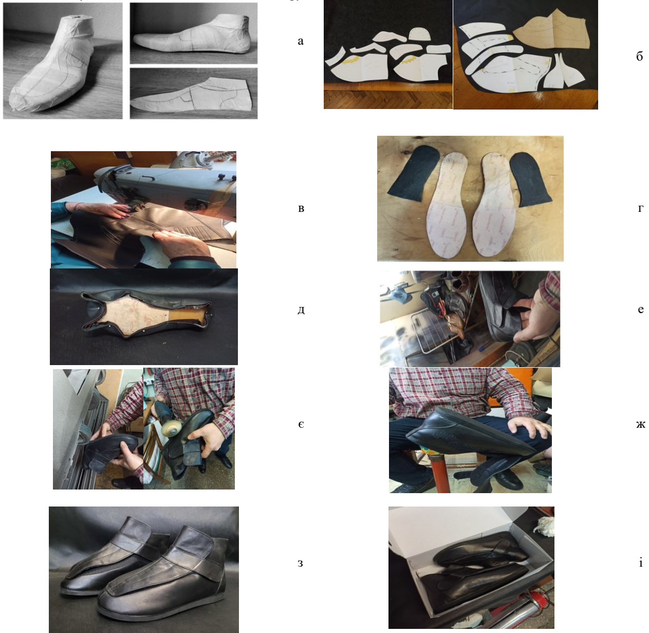
а - процес проєктування ортопедичного взуття з урахуванням анатомічних особливостей стоп за адаптованою італійською методикою; б - розкрій деталей верху і підкладки взуття; в – складання деталей заготовки на швейному обладнанні; г – виготовлення вузла основної устілки ; д - формування пари взуття на колодці; е - прикріплення підошви; є – комплекс опоряджувальних операцій; ж – зняття взуття з колодки; з – оцінка якості готового виробу; і – упаковка виробу. Рис.5. Етапи виготовлення ортопедичного взуття для діабетиків за індивідуальним замовленням
