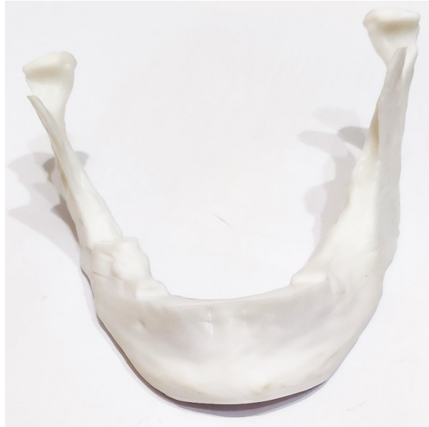
Рис. 8. Фото щелепи виготовленої шляхом 3D друку
