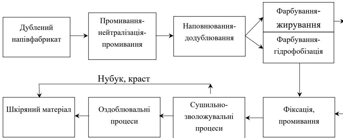
Рис. 1. Технологічна схема формування еластичного шкіряного матеріалу
