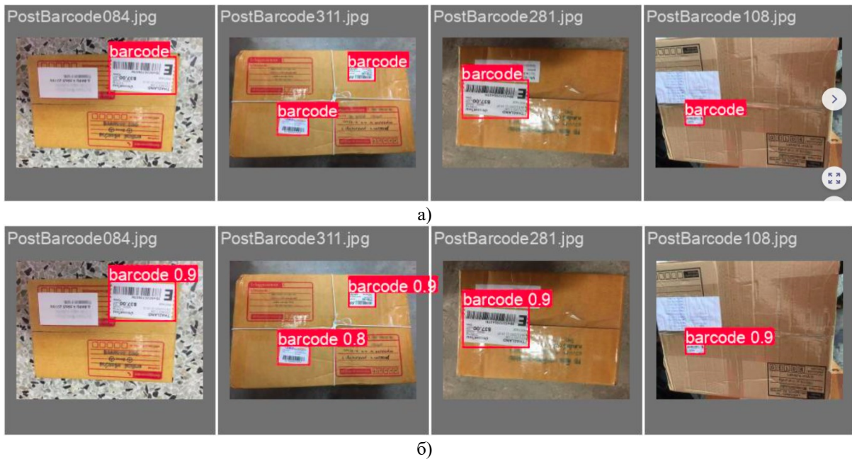
Рис. 6 – Приклади міток датасету ParcelBar (a) і виявлення моделлю YOLOv8_3 (б)
