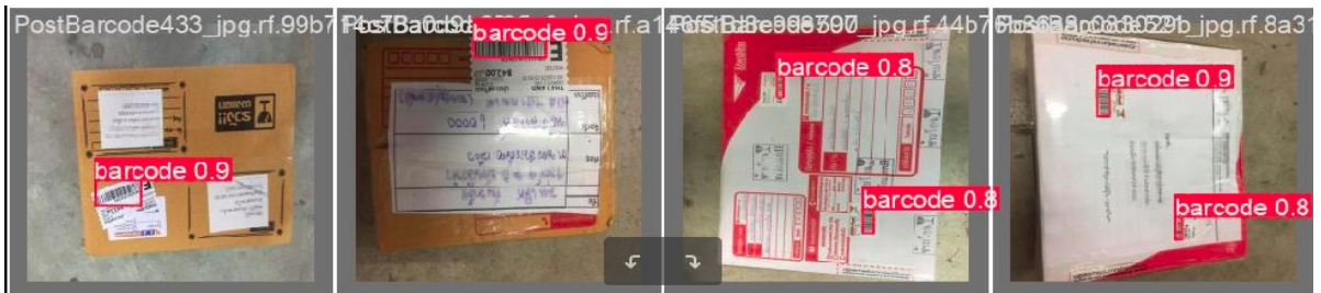
Рис. 7 – Приклади виявлення штрих-кодів моделлю YOLOv8_5 на валідаційних даних
