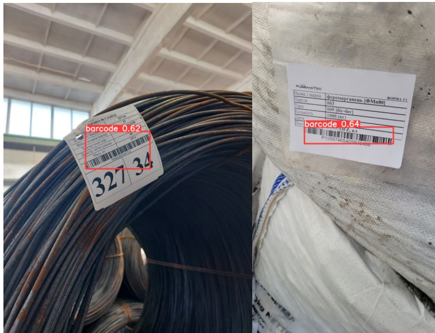
Рис. 9. Результати виявлення штрих-кодів моделлю YOLOv8_7 на зображеннях з сировинною продукцією
